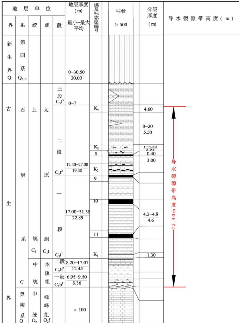
图 8-3-5 铁矾土矿导水裂缝带高度示意图
