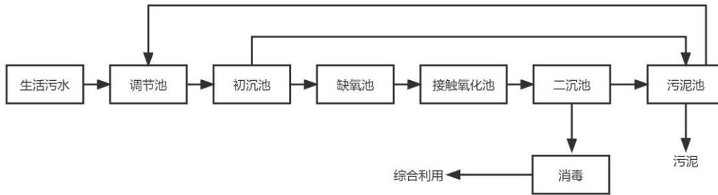
图8-3-12 生活污水处理工艺流程图
