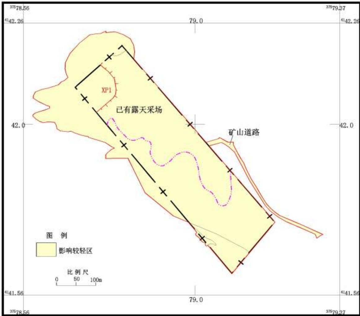
图 8-2 含水层影响和破坏程度现状评估分区图
