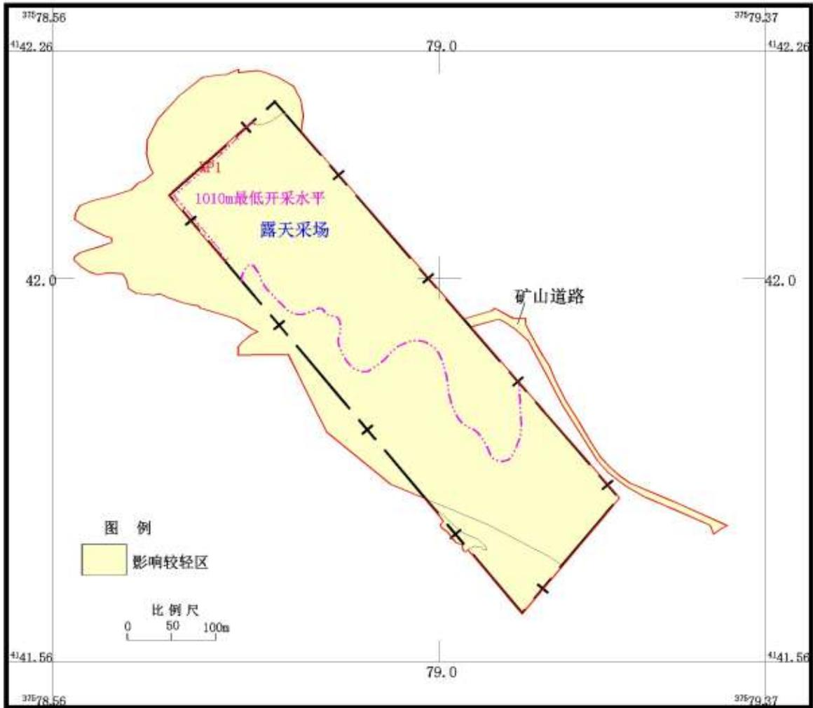
图 8-6 含水层影响和破坏程度预测评估分区图
