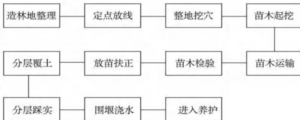
图 11-6-2 绿化种植施工流程示意图
